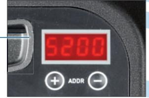
Display zur Anzeige von Helligkeit, Farbtemperatur und Funkkanal (Funkfernbedienung als optionales Zubehör).
