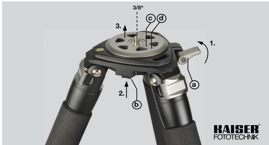
Mit den Madenschrauben (c) und (d) kann mittels Innen-sechskantschlüssel SW3 (3 mm) ein Stativkopf (Kugelkopf/Videokopf) auf der Montageplatte fixiert werden.
