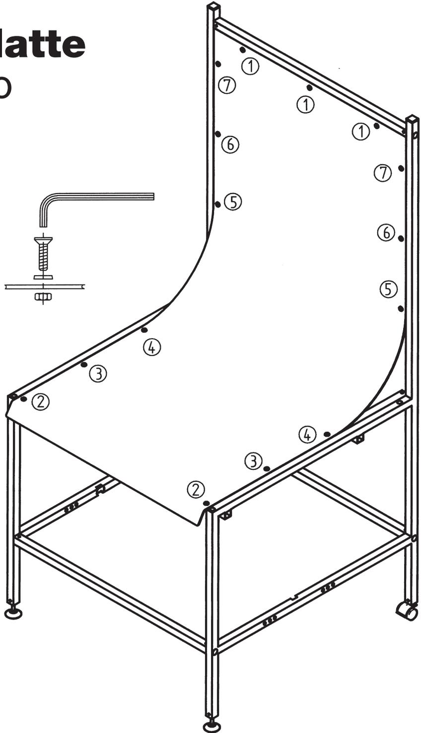
Bitte bei Montage der Plexiglasplatte unbedingt Reihenfolge 1 - 7 beachten. Zuerst alle 15 Schrauben locker andrehen und dann erst (leicht) anziehen.
