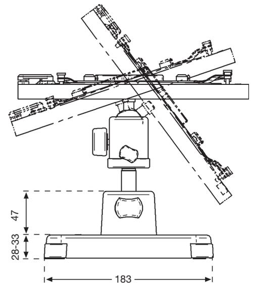
Die Halteplatte kann vom Kugelgelenk abgenommen und durch die als optionales Zubehör erhältliche Tiltall Schnellwechselplatte 6004 (Länge 40 mm) oder eine andere Tiltall Schnellwechselplatte ersetzt werden (siehe Bedienungsanleitung Tiltall Kugelköpfe).
