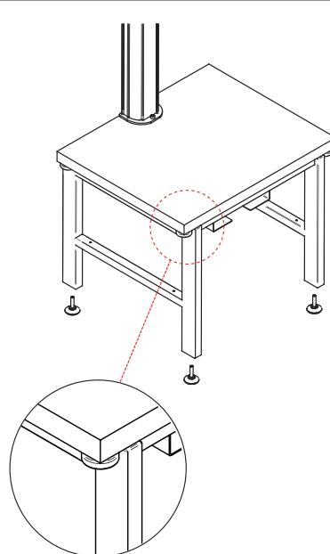
Zur Verwendung mit dem Grundbrett des Reprostativs RSD (68 x 57 cm) kleben Sie bitte die vier beiliegenden, selbstklebenden Elastikpuffer (1) als Rutschsicherung auf das Untergestell.
